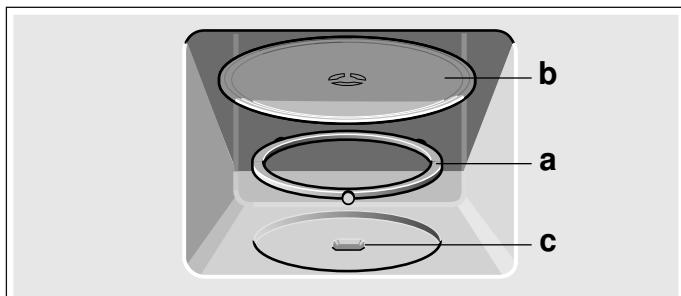
**Conselho:** Utilize o aparelho apenas com o prato rotativo colocado. Certifique-se de que está encaixado corretamente. O prato rotativo pode girar para esquerda ou para a direita.
