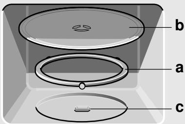
**Nota:** Utilizar el aparato solo con el plato giratorio colocado. Comprobar que esté correctamente encajado. El plato giratorio puede girarse hacia la derecha o hacia la izquierda.
