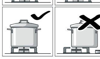
Coloque o recipiente bem centrado sobre o queimador. Caso contrário, o recipiente poderá virar-se. Não coloque os recipientes grandes sobre os queimadores próximos dos comandos. Estes podem ficar danificados devido ao excesso de temperatura.
