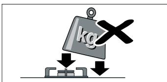
Τοποθετήστε τα σκεύη πάνω στις σχάρες, ποτέ απευθείας επάνω στον καυστήρα. Βεβαιωθείτε πριν από τη χρήση ότι οι σχάρες και τα καλύμματα των καυστήρων είναι καλά τοποθετημένα. Χειριστείτε τα σκεύη με προσοχή πάνω στη βάση εστιών. Μην χτυπάτε τη βάση εστιών, και μην τοποθετείτε πάνω της υπέρβαρα αντικείμενα.
